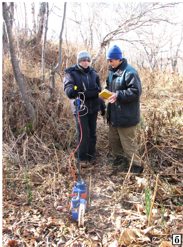
Рис. 3. Работа георадаром «ОКО» с применением антенных блоков (фото Е.А. Кравчуновской): а – АБ-250; б – АБ-700; в – АБД «Тритон».
