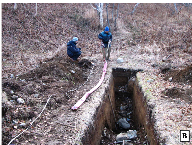
Рис. 3. Работа георадаром «ОКО» с применением антенных блоков (фото Е.А. Кравчуновской): а – АБ-250; б – АБ-700; в – АБД «Тритон».
