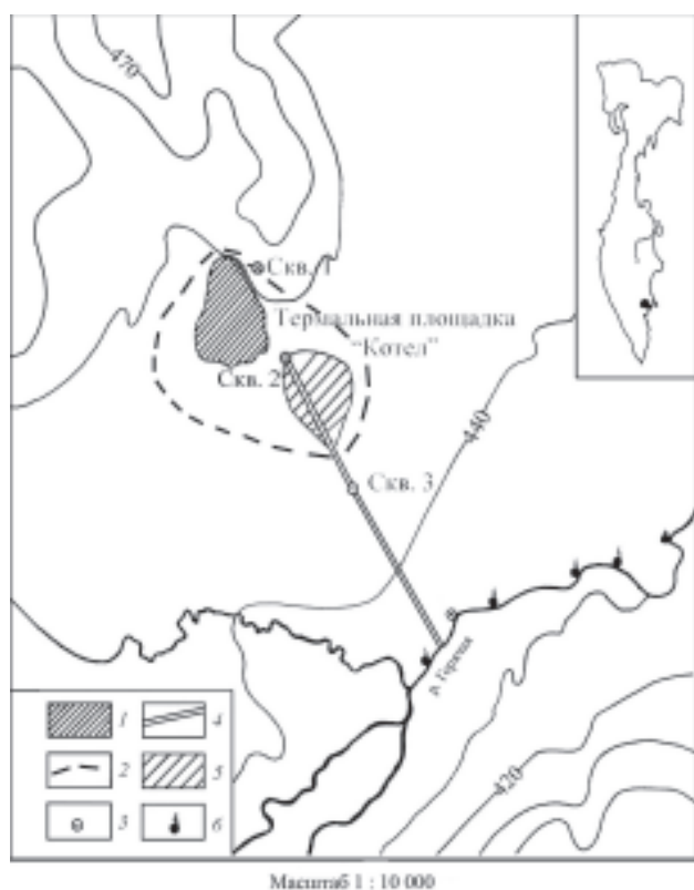
Рис. 1. Схема расположения грифона Иванова и антропогенной дренажной системы (составлена с использованием данных Масуренкова, Комковой, 1978). 1- выходы осадков термальной площадки «Котел»; 2- предполагаемые контуры термальной площадки «Котел»; 3- гидрогеологические скважины и их номера; 4- дренажная траншея; 5- современные осадки дренажной системы; 6 - термальные источники.
