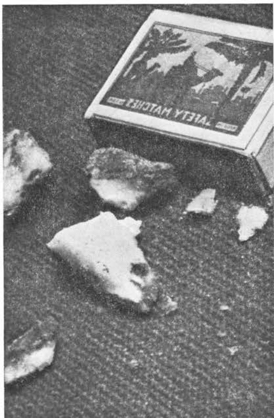
Рис. 5. Внешний вид газогидрата, поднятого с илом над ППГИ (11-й А рейс НИС «Академик Мстислав Келдыш», июнь 1986 г.)
