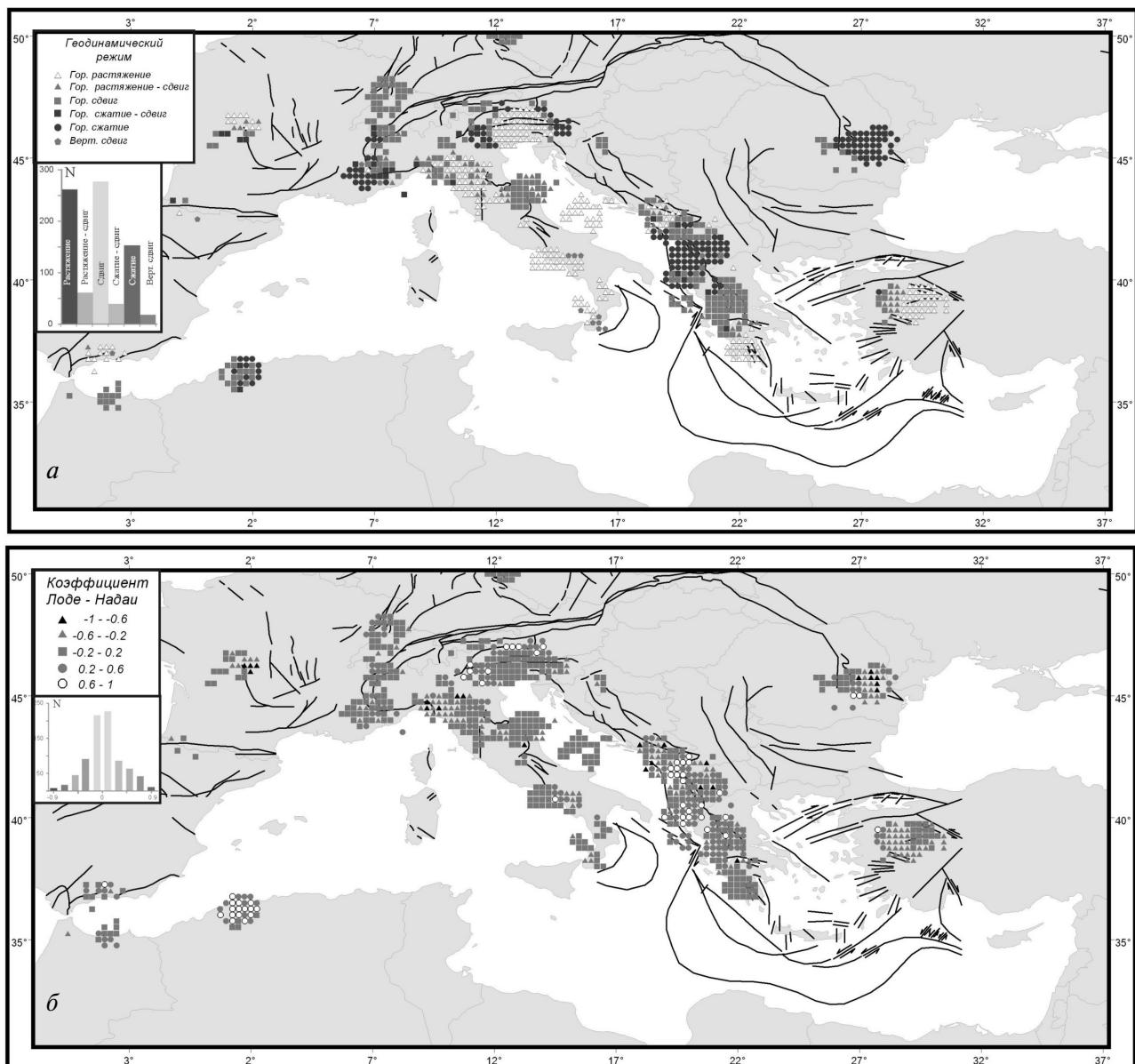
**Рис. 7.** Параметры эллипса напряжений, полученные по данным каталога  $1.8 \leq M_b \leq 5.0$ : геодинамический тип напряженного состояния (а), коэффициент Лоде – Надаи (б).
