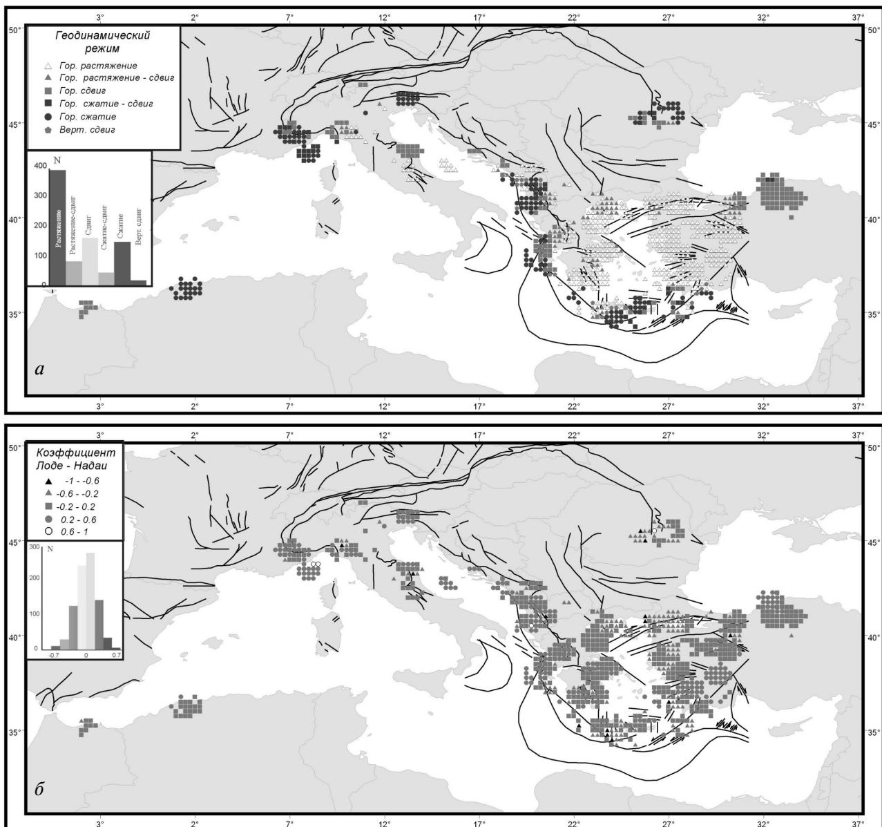
**Рис. 9.** Параметры эллипсоида напряжений, полученные по данным каталога  $4.0 \leq M_b \leq 6.5$ : геодинамический тип напряженного состояния (а), коэффициент Лоде – Надаи (б).
