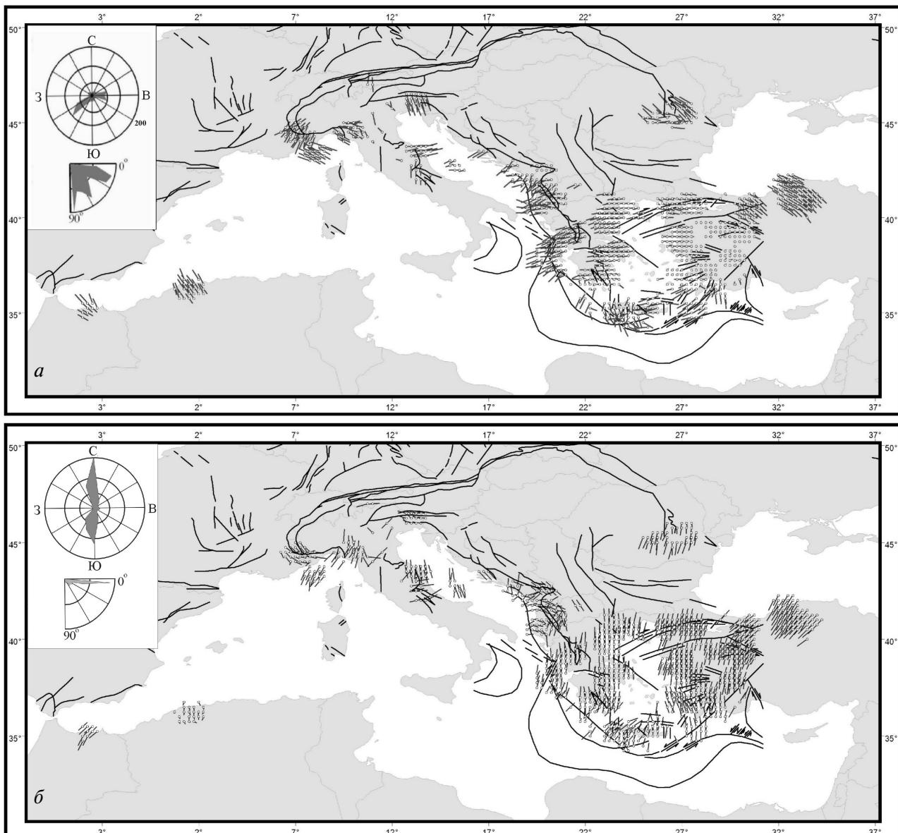
**Рис. 8.** Параметры эллипсоида напряжений, полученные по данным каталога  $4.0 \leq M_b \leq 6.5$ : проекции на горизонтальную плоскость осей погружения алгебраически максимальных  $\sigma_1$  (а) и минимальных  $\sigma_3$  (б) главных напряжений. В верхнем левом углу показаны розы – диаграммы представительности простираций и углов погружения соответствующих осей главных напряжений.
