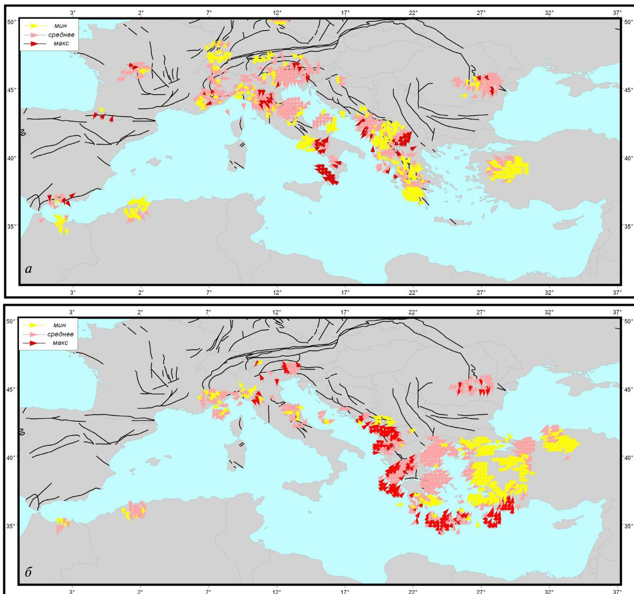
**Рис. 10.** Ориентации и относительные величины (нормировка на максимальные касательные напряжения) поддвиговых касательных напряжений, действующих на горизонтальных площадках с нормалями, ориентированными к центру земли: а) каталог  $1.8 \leq M_b \leq 5.0$ ; б) каталог  $4.0 \leq M_b \leq 6.5$ . Даны градации интенсивности нормированных касательных напряжений по трем уровням: низкая, средняя и максимальная интенсивность.
