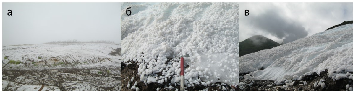
Рис. 1. Примеры силикатных отложений в окрестности скважин Мутновского геотермального месторождения: а – отложения в окрестности скважин 019 и 022; б – силикатный снег на снежнике в окрестности скважины 047; в – пароводяная струя от скважины 047 на фоне силикатных отложений и снежника.
