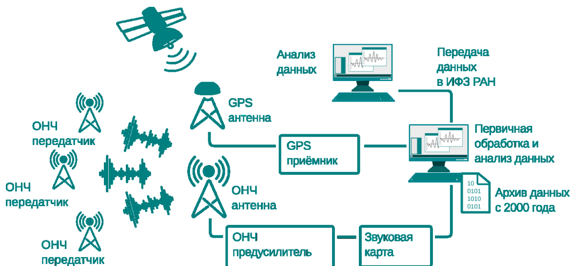
Рис. 2. Упрощенная схема получения и обработки данных на приемном центре РТК.
