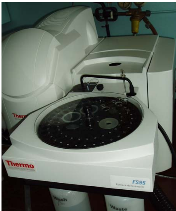
Рис. 4. Электротермический атомизатор ЭТА (графитовая кювета) с автосамплером.
