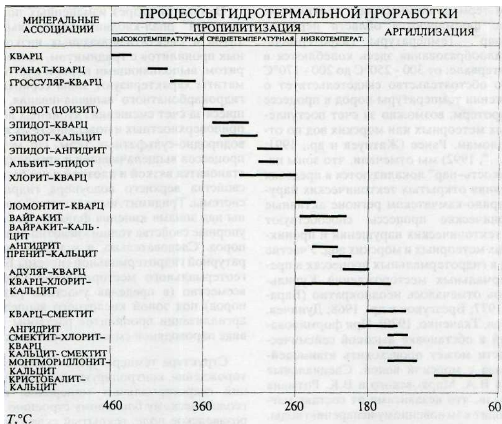
Фиг. 4. Температурные условия гидротермального изменения пород и образования минералов из растворов геотермального месторождения Океанское.
